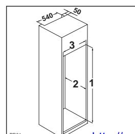
Umístezte příslušenství do určeného prostoru a opřete jej o vnitřní stěnu skříně, která odpovídá straně otevření dveří, až do úplného zasunutí horní desky (1). Ujistěte se, že je spodní závěs souběžný se stěnou skříně. (2).
