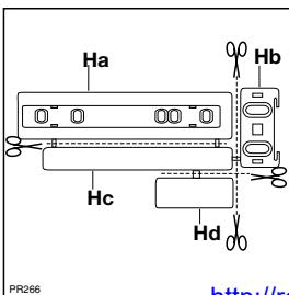
Приложите направляющую (На) к внутренней стороне дверцы кухонного шкафа сверху и снизу, как показано на рисунке, и отметьте положение наружных отверстий. Просверлив отверстия, прикрепите направляющую с помощью прилагаемых винтов.
