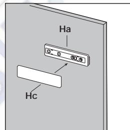
Otworzyć drzwi urządzenia i drzwi frontu meblowego pod kątem 90°. Umieścić małe nakrętki kwadratowe (Hb) na prowadnicy (Ha). Złożyć razem drzwi urządzenia z drzwiami frontu meblowego i zaznaczyć otwory tak, jak to pokazano na rysunku.
