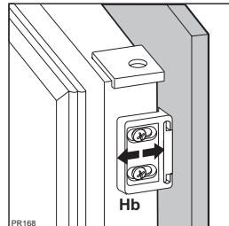
Přimontujte kryt (Hd) na drážku (Hb) tak, aby zaskočil na místo.
