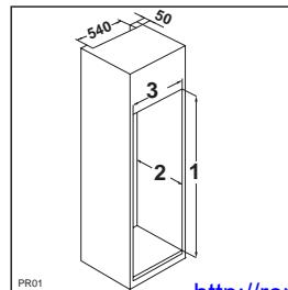
Wsunąć urządzenie do wnęki opierając je o wewnętrzna ścianę odpowiadającą stronie otwarcia drzwi do momentu gdy górnego przykrycie fugi dopasuje (1) i upewnić się, aby dolny zawias znalazła się w linii ze ścianą mebla (2).
