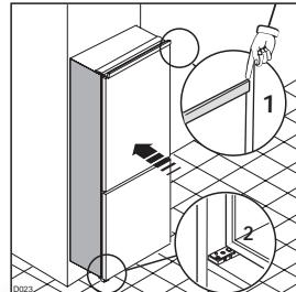
Zamocować urządzenie 4 śrubami wchodząącymi w skład wyposażenia. (I = Krótka) (P = Długa).
