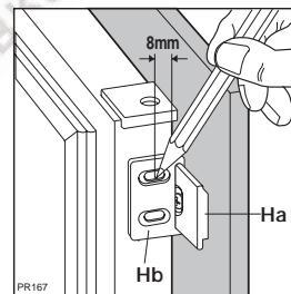
Odstraňte úhelníky a vyznačte bod 8 mm od vnějšího kraje dveří pomocí šroubu (K).
