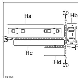
Umístěte drážky (Ha) na vnitřní stranu dveří linky, jak je to ukázáno na ilustraci a označte si pozici vnějších otvorů. Po vyvrtání děr připevněte drážky pomocí šroubů z příslušenství.
