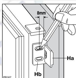
Снимите кронштейны и отметьте расстояние 8 мм от внешнего края дверцы для гвоздя (К).
