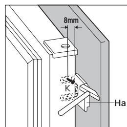
Ponownie założyć nakrętki na prowadnicy i zamocować je śrubami dostarczonymi w wyposażeniu.
