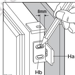
Wyjąć kątownice i zaznaczyć odległość 8 mm od zewnętrznego brzegu drzwi za pomocą gwoździa (K).
