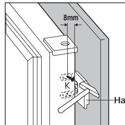
Helyezze fel újra a kis téglalapot a vezetőlécre és rögzítse a csomagban található csavarokkal. 8mm
