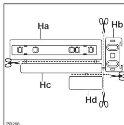
Prowadnicę (Ha) zamocować na wewnętrznej części drzwi frontu meblowego, zgodnie z wskazówkami podanymi na rysunku i zaznaczyć pozycje otworów zewnętrznych. Po wywiercieniu otworów należy zamocować prowadnicę dostarczonymi w wyposażeniu śrubami.
